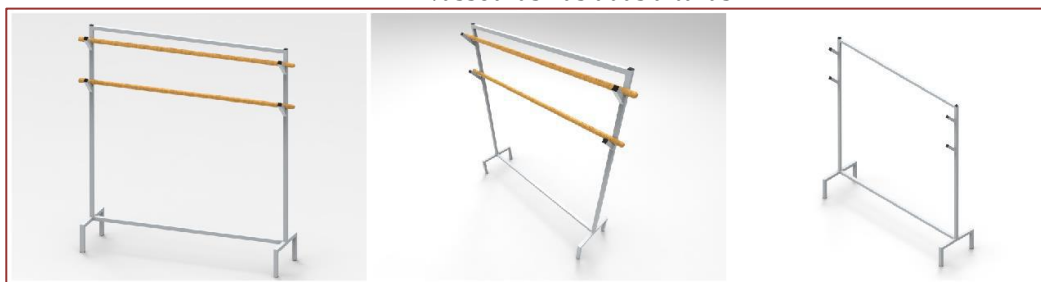
Figura 15 - Dispositivo para pintura de cabos de vassoura com simulação de dispositivo e cabos de vassouras nas duas alturas.
