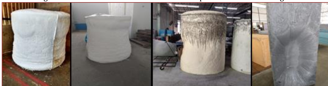
Figura 01: Perdas com não conformidade de espuma cilíndrica e retangular
