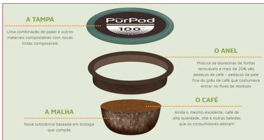
Figura 3 - Estrutura da Cápsula Compostável
