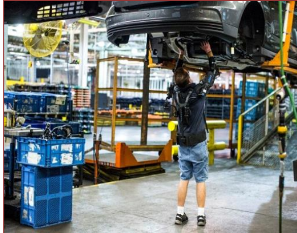
Figura 3: Utilizando exoesqueleto para manutenção mecânica
