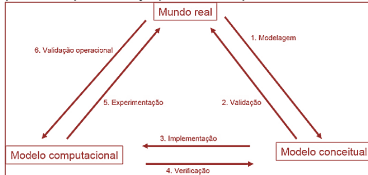
Figura 1 – A verificação e validação em um projeto de simulação. Fonte: Chwif e Medina (2006)
