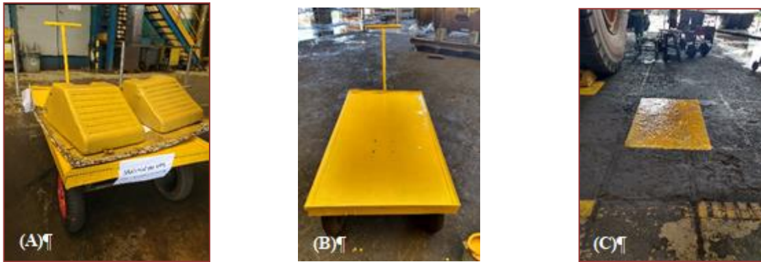
Figura 2 – (A) Calços exclusivos para um determinado box de manutenção, (B) Carrinho de Transporte exclusivo do box de manutenção e (C) Local de alocação do carrinho quando este não se encontra em uso.
