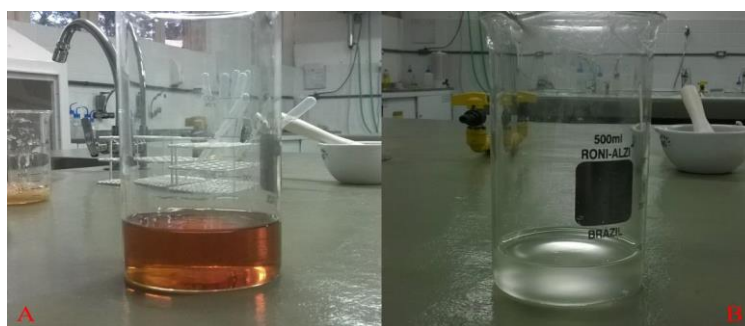
Figura 5: Produtos finais obtidos, biodiesel de óleo residual (A) e do óleo de coco (B)
