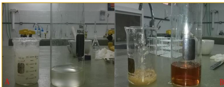
Figura 3: Separação do biodiesel e a glicerina, provenientes das reações com óleo de coco (A) e óleo residual de fritura (B)
