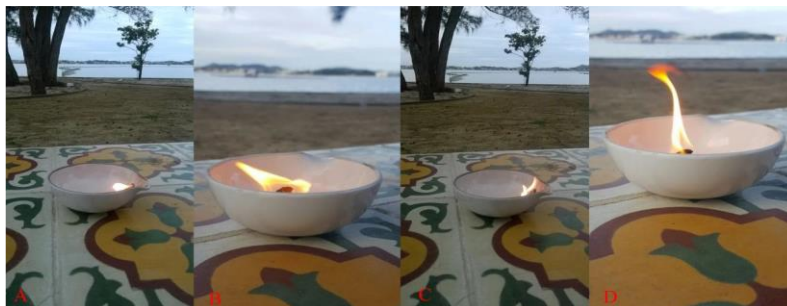
Figura 4: Teste de combustão para o óleo de coco (A), o biodiesel de óleo de coco (B), o óleo residual de fritura (C) e o biodiesel do óleo de fritura (D)
