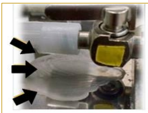
Figura 5- Válvula apresentando vazamento de solvente
