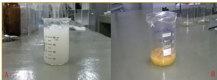
Figura 6: Glicerina produzida durante o processo, do biodiesel obtido a partir do óleo de coco (A), do óleo residual de fritura (B)
