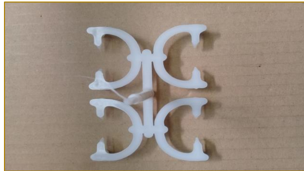
Figura 02 – Exemplo de galho de injeção, onde podemos ver as 6 partes constituintes, conforme figura 01.
